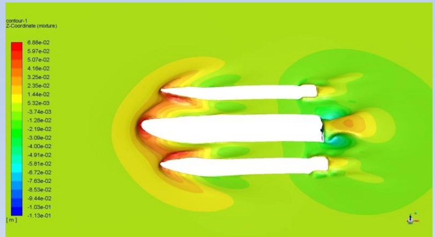
CFD симулация на вълновото взаимодействие между тримаранските корпуси
